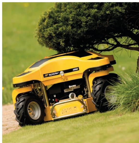
Der **Spider MINI II** ist der kleinste der Spider Hang- und Böschungsmäher, steht aber mit seiner Kletterfähigkeit und Wendigkeit nicht weit hinter den kommerziellen Modellen ILD01 und ILD02 zurück.
